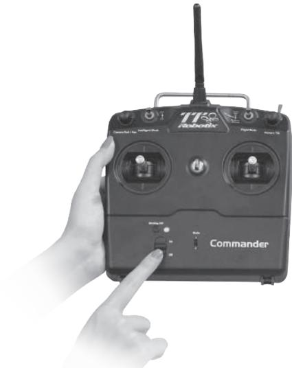
1. インテリジェントモード、フライトモード、ランディングスキッド・スイッチが最上部に切り替わっていることを確認してください。
