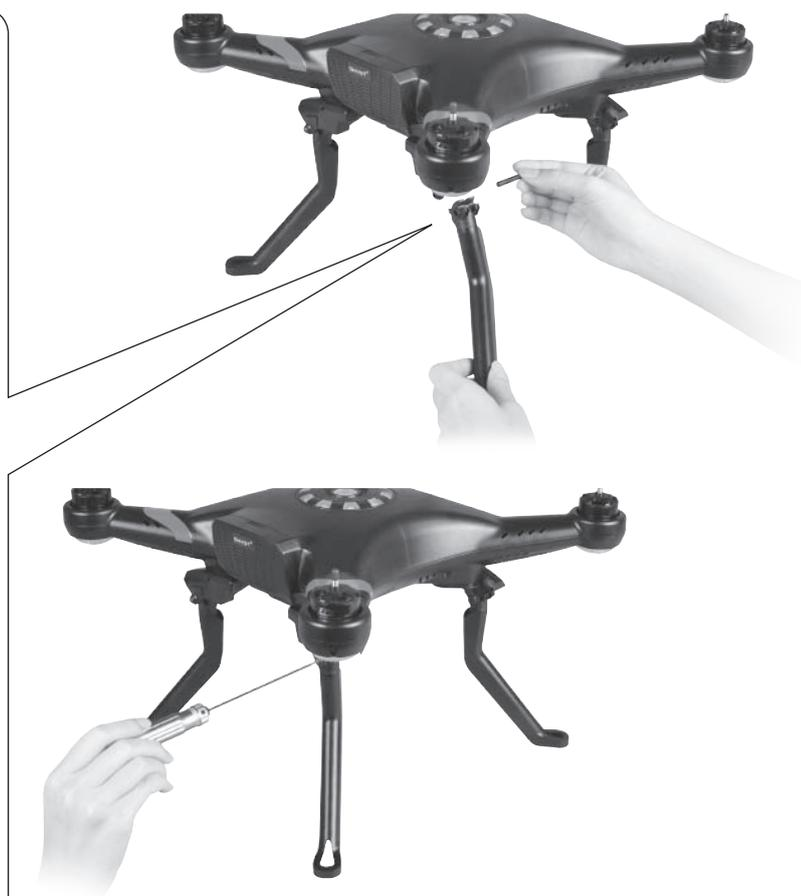
ランディングスキッドを本体に図示に従って装着し、ボルトで確実に固定してください。
